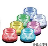
イベント装飾や個室トイレなどの「使用中 / 空き」の表示、各種機器 の動作表示などに適した表示灯です。入力は3入力で、各入力に赤発光・ 緑発光・青発光が対応。複数同時入力での最大 7 色発光で状態区別が 可能です。
